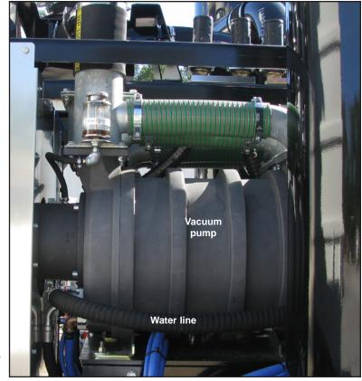
DUAL LIQUID RING - BLOWER (VACUUM PUMP) - AIR FLOW
